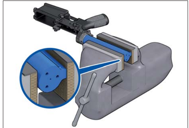
Abb. 12a: Verlängerung in Schraubstock einspannen
