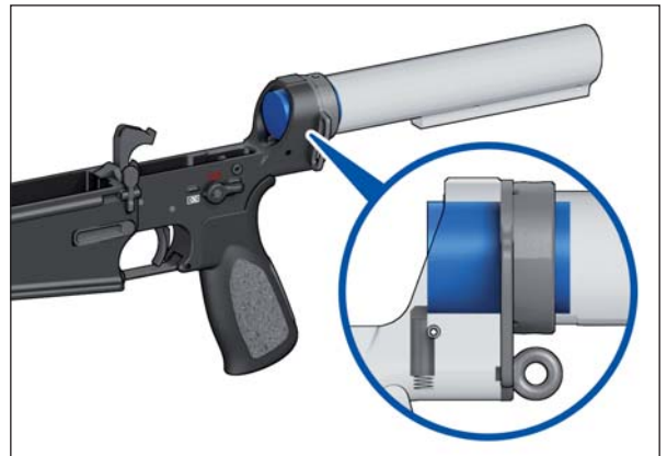
Abb. 15b: Rundmaterial in Verlängerung einsetzen
